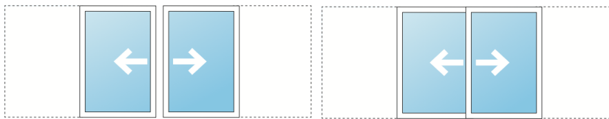
Le galandage 1 vantail sur 1 rail ou 2 vantaux sur 1 rail nécessite une épaisseur d'isolation de 180 mm
