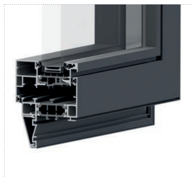
Section d'aluminium ultra fine : dormant + ouvrant = 66 mm
